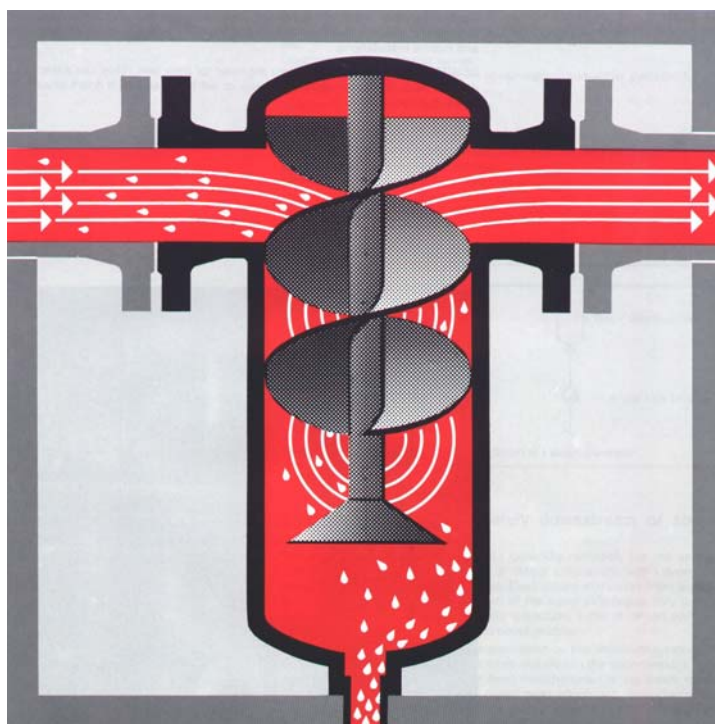
Rysunek 9. Zasada działania osuszacza z podwójną spiralą [1].
