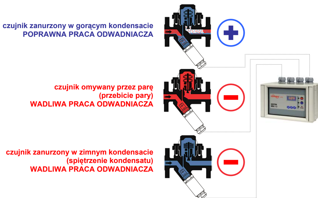
Rys. 5 Sposób pracy systemu detekcji przewodności przepływającego czynnika w połączeniu z pomiarem temperatury.
