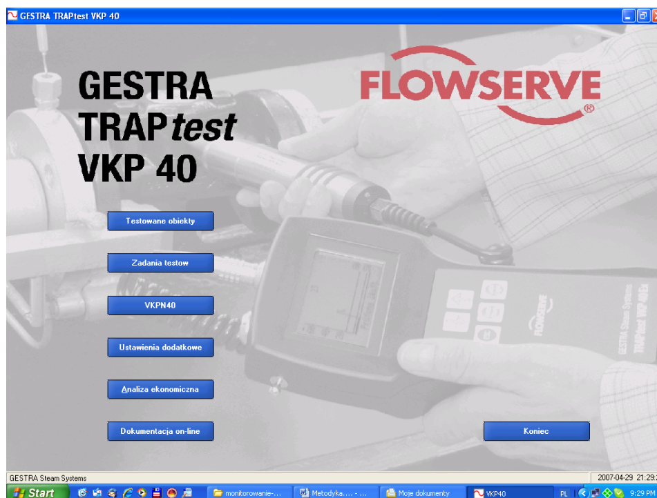
Rys.11 Oprogramowanie VKP40 umożliwiające przyjazną użytkownikowi obsługę baz danych i wyników za pomocą PC.
