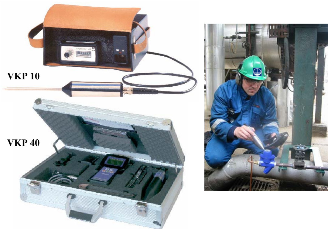
Rys.6 Urządzenia do ultradźwiękowej kontroli odwadniaczy i sposób ich wykorzystania
