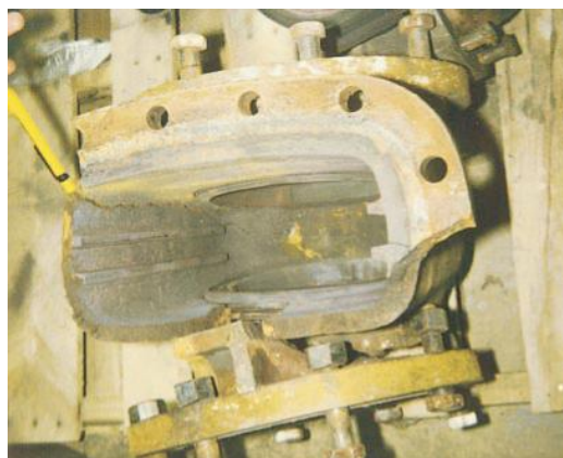
Rysunek 6. Żeliwne zasuwki rozerwane na skutek uderzeń wodnych w rurociągach parowych.
