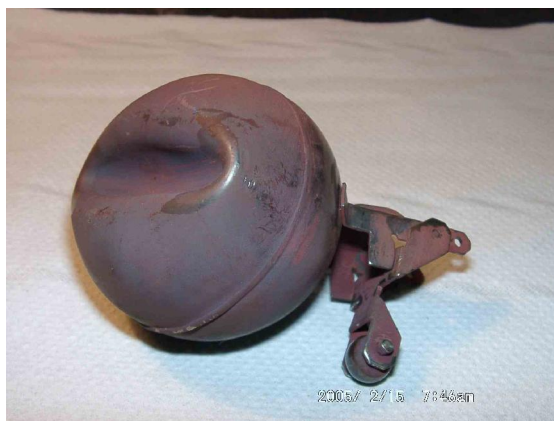
Rysunek 9. Uszkodzenie pływaka kulowego odwadnicza pływakowego na skutek uderzenia wodnego.
