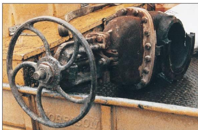
Rysunek 6. Żeliwne zasuwki rozerwane na skutek uderzeń wodnych w rurociągach parowych.
