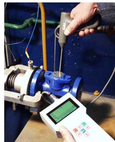
Rys.2 Pomiar poprawności działania odwadniacza metodą ultradźwiękową – GESTRA VKP 30
