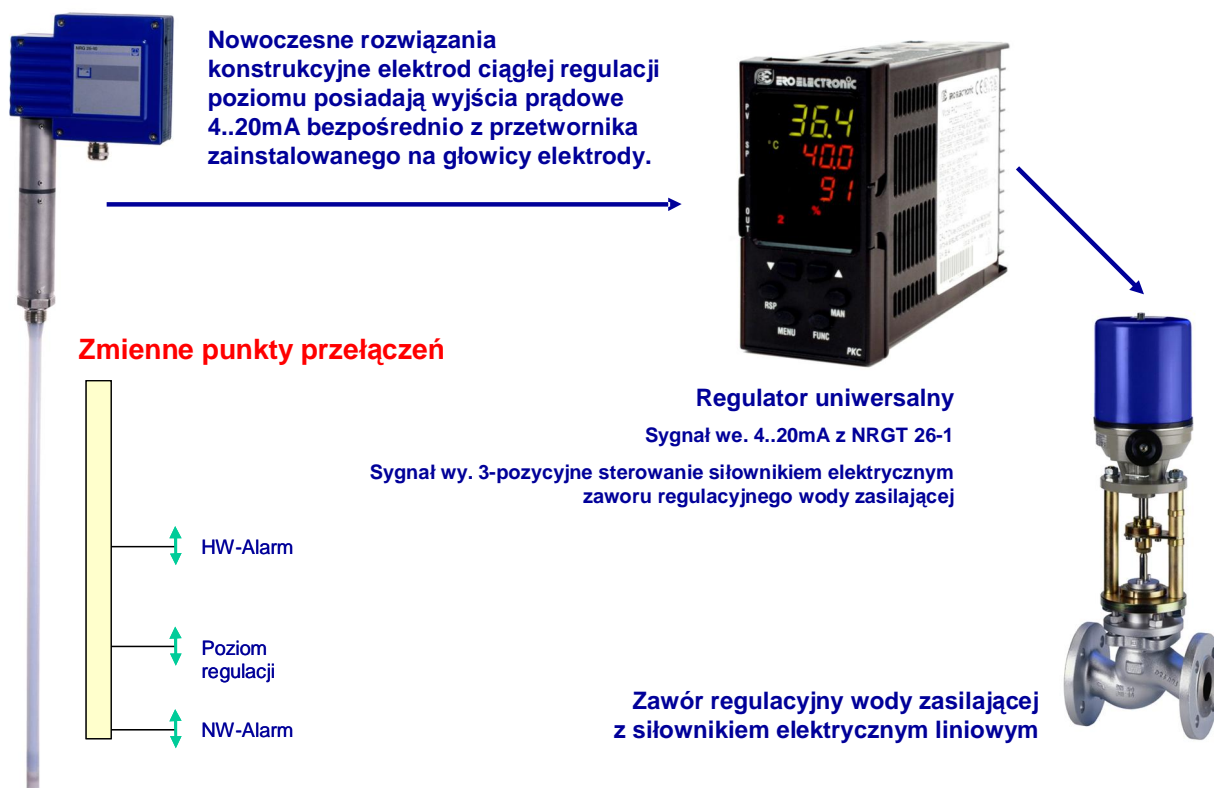
Rysunek 4. Jednoimpulsowa modulowana regulacja poziomu
