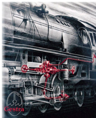
Rys. 1 Zawór odmulający GESTRA do parowozu (1902 r.)
