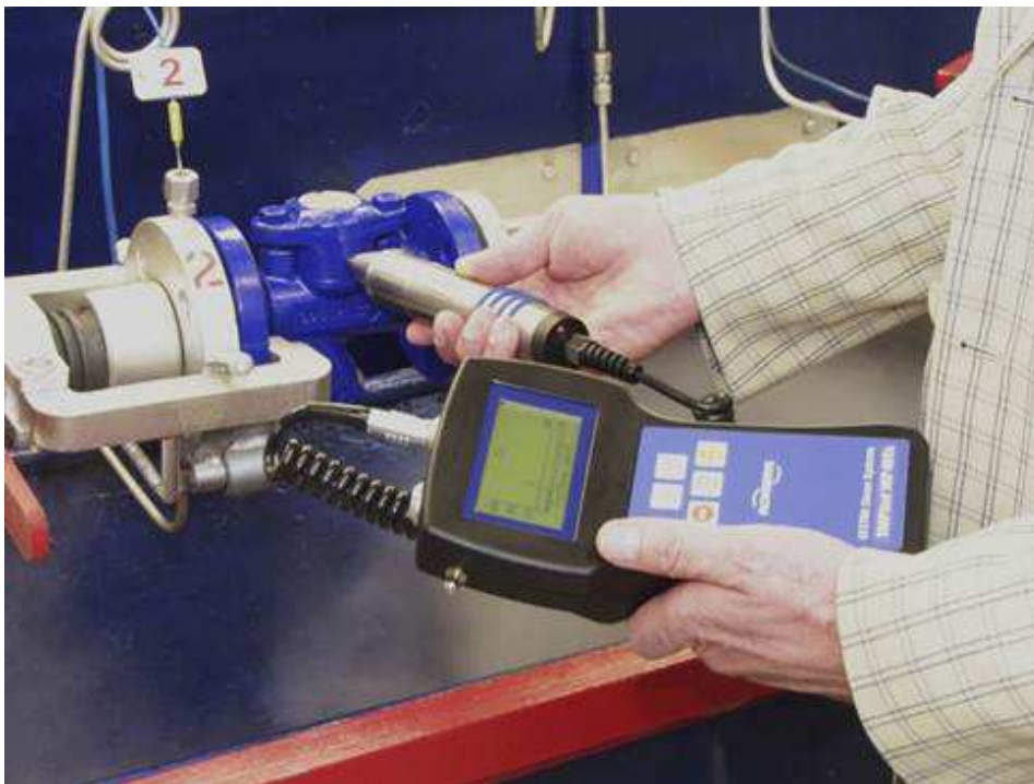
Rys.2 Pomiar poprawności działania odwadniacza metodą ultradźwiękową VKP-40
