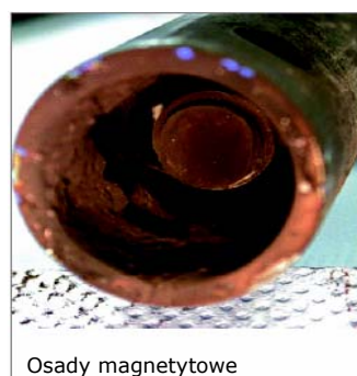
Rys 5. Wpływ powłok i osadów na powierzchniach pomiarowych elektrody pomiaru przewodności na zaniżanie wartości pomiaru
